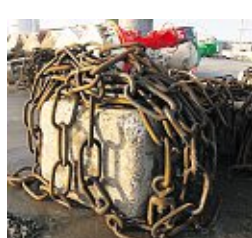
Etwa zwei Tonnen wiegt der Ankerstein, die Kette misst 40 Meter.
