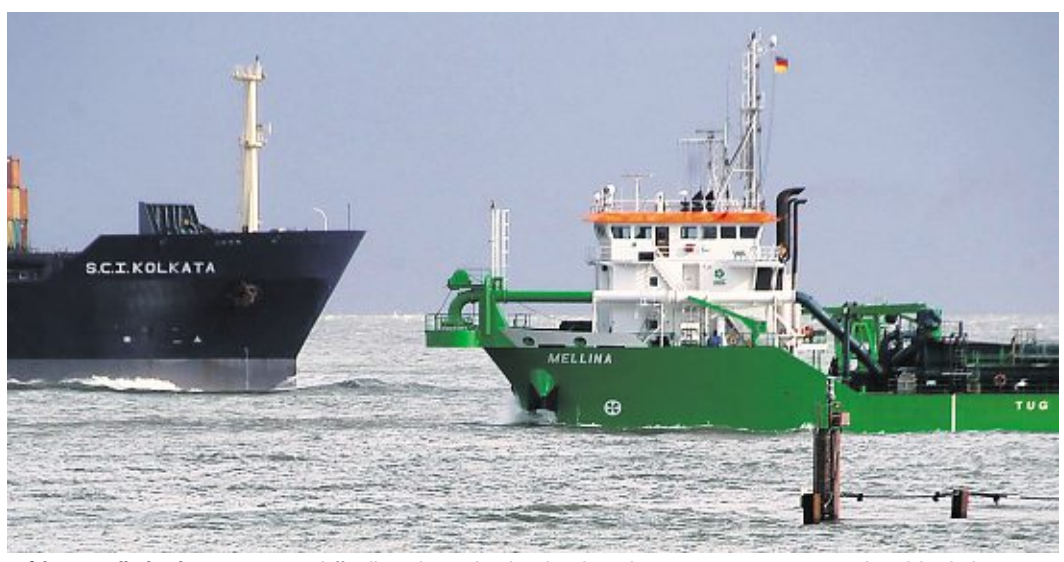
Auf der Unterelbe im Einsatz: Das Baggerschiff Mellina gehörte neben der Lelystad, J. Möbius, Ham 316, Geopotes 14, Marieke und der Charlemagne zur Flotte der Hopperbagger, die die Fahrrinne nach Hamburg frei halten. 11,9 Millionen Kubikmeter Baggergut fielen vergangenes Jahr an. Fotos: Heidtmann
